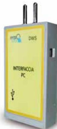
L'interfaccia PC, è il dispositivo che rende possibile lo scambio dei dati tra i dispositivi che compongono il sistema DWS e i computer del centro di gestione. Tramite l'Interfaccia PC è anche possibile riprogrammare il firmware del gruppo di consegna.
